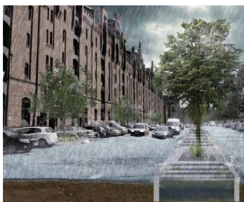
Obrázek 3: Návrh situace spojovací silnice (vlevo), plánování uličního prostoru citlivé k vodě s absorpční stromovou mřížkou (vpravo) [FHH 2015]
