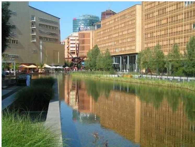
Obr. 6: Umělé jezero zásobované dešťovým odtokem ze střech na Potsdamer Platz
