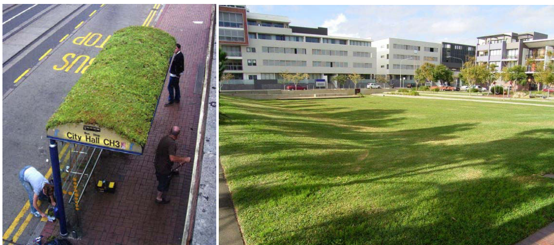
Obr. 5: vlevo: Zelená střecha ve Velké Británii, která plní zejména osvětové a vzdělávací účely (zdroj www.ciria.org ); vpravo: zasakovací průlehu v Sydney, Austrálie (zdroj: www.wsud.org ).
